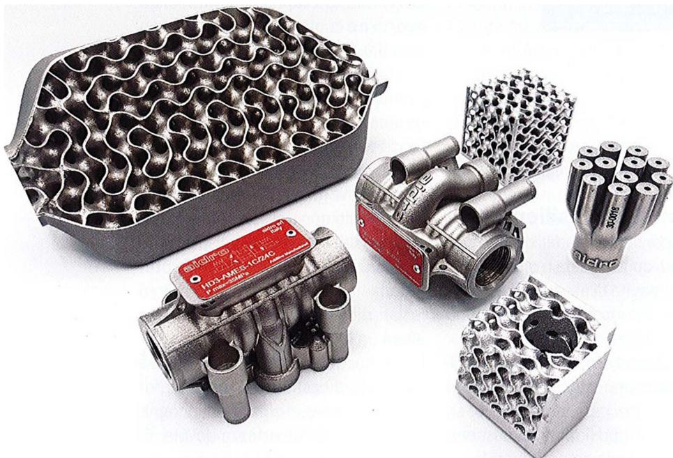
AIDRO ALCUNI ANNI FA HA INIZIATO A PROGETTARE IN ADDITIVO, STAMPANDO I PRIMI PEZZI CON LA SINTERIZZAZIONE LASER DI POLVERI METALLICHE, INVESTENDO IN UNA STAMPANTE 3D DELLA EOS CON TECNOLOGIA DMLS.
