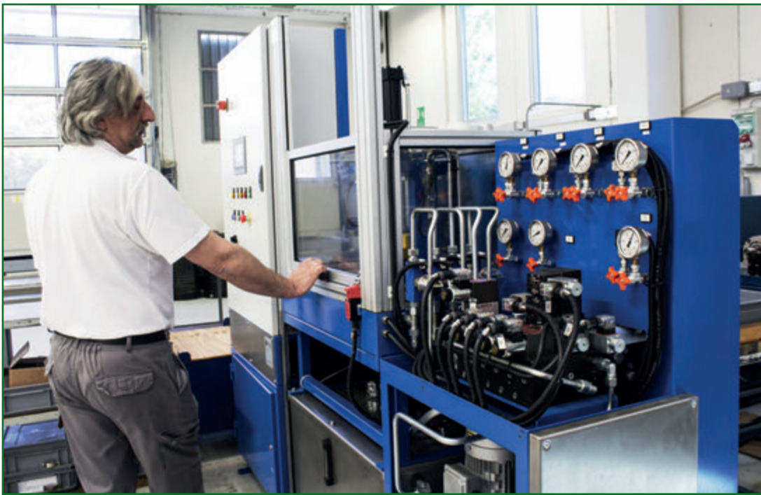
● Banco di collaudo per un manifold valvola prodotto con la stampa 3D. ● Test bench for a 3D printing valve manifold.
