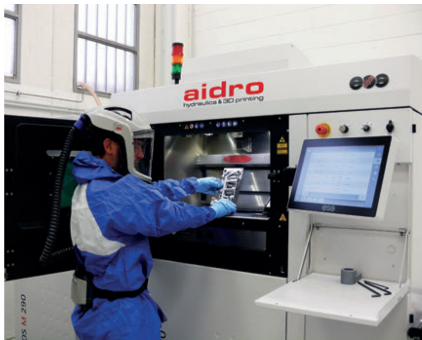
● La produzione di un manifold con la macchina EOS M290 installata presso Aidro. ● The production of a manifold on AN EOS M290 machine at Aidro.
