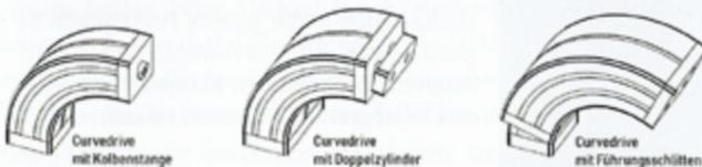
Das Prinzip des Curvedrive-Zylinders lässt sich in verschiedenen Versionen realisieren. Kraft und Geschwindigkeit ist über den gesamten Weg gleich, außerdem spart die Konstruktion Platz gegenüber den üblichen Hebel-Konstruktionen.
