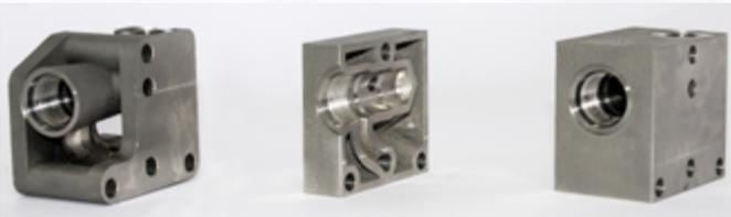
Aidro stellt in additiver Fertigung hydraulische Anschlussplatten, Wärmetauscher, Spulen und Ventilblöcke her. Neben einer fast baugleichen Variante (Mitte), spart die Neukonstruktion (links) noch einmal deutlich mehr Gewicht ein.
