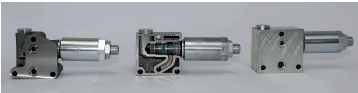
De mogelijkheden om gewicht te besparen komen in deze foto goed tot uitdrukking. Links een traditioneel vervaardigd ventiel, daarnaast een 3D-geprint model dat al 40 procent minder weegt en helemaal rechts de uiteindelijke vorm, 60 procent lichter dan het uitgangsmodel.
